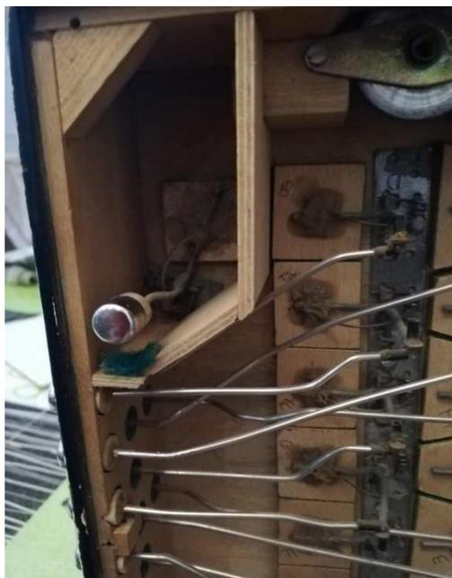
Afin de compenser la perte de surface de sortie d'air des basses, la planche qui recouvre les mécaniques basses a été percée pour éviter un changement dans la nature du son. Ce perçage c'est d'abord fait à l'identique de la surface isolée puis ensuite ajusté en fonction de l'essai pour enfin être colmaté d'un cache poussière.
